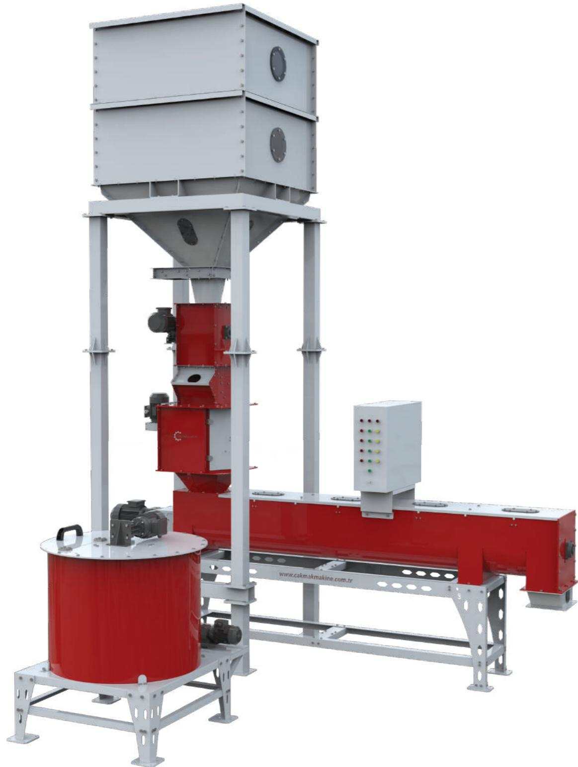
Tohumların haşere'lere, mantarlanmaya veya yapı maddelerinin bozulmasına karşı korumak için hassas bir şekilde kimyasal ilaçlar ile kaplanması sağlanan bir makinedir. Besleme ünitesinden makineye alınan ürüne, kaplama tankından alınan kaplama sıvısı iki kademe'de uygulanır. Arpa, buğday ve benzeri tahılların karışım sırasında ürüne zarar vermeden ilaçlanması yapılabilir.
